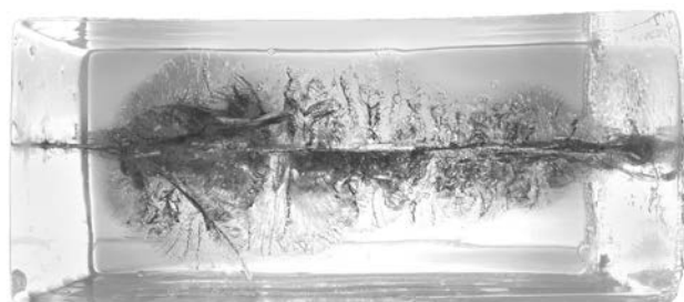
Simulazione della traccia energetica nella gelatina balistica
