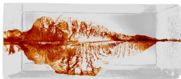
Simulazione della traccia energetica nella gelatina balistica
